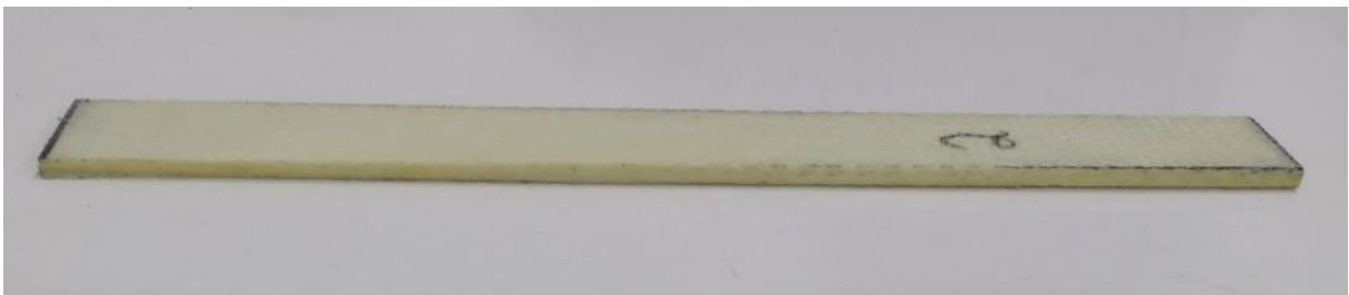
Figura 17: Placa do compósito Syntho-Glass® XT
